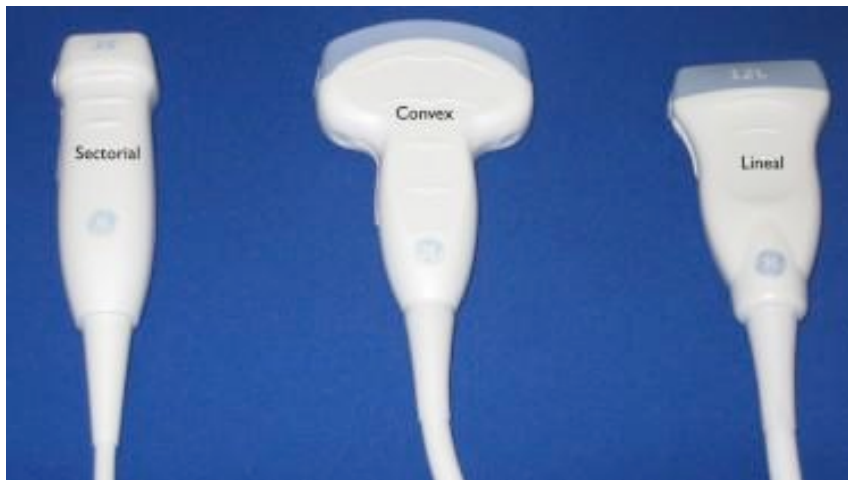
Fig. 1-11. Diferentes tipos de transductores o sondas. Obsérvese cómo todos tienen un marcador ("muesca") a la izquierda.
