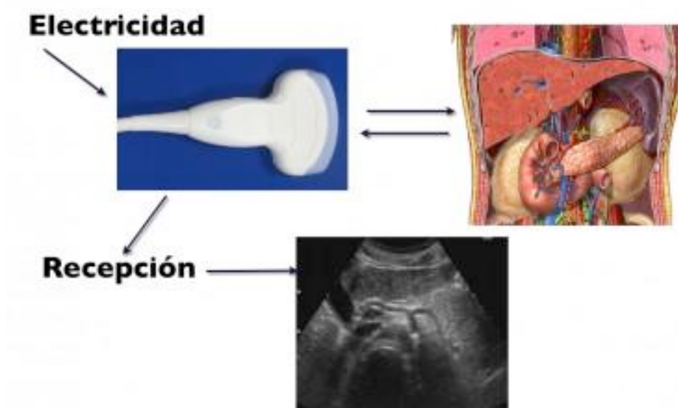
Fig. 1-4. Elementos o constituyentes de un ecógrafo.
